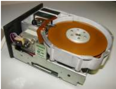
1980-cı illərdə istehsal olunan müxtəlif tutumlu sərt disklər
