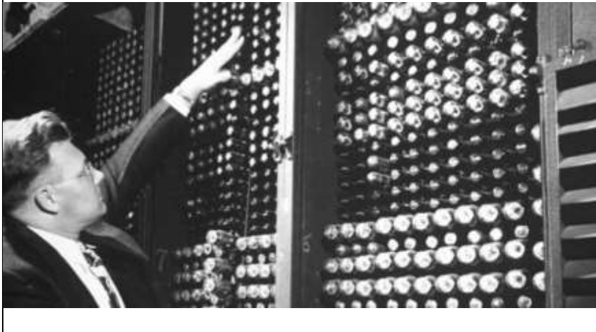
Keçən əsrdə hazırlanmış operativ yaddaş qurğuları
