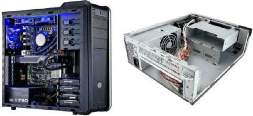
Şəkil 5. Üfq və şaquli quruluşlu sistem bloku
