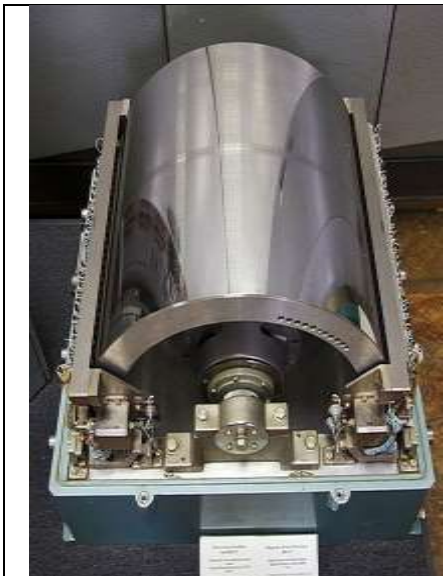
Keçən əsrdə hazırlanmış operativ yaddaş qurğuları
